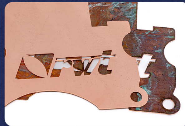
Odstranění oxidace mědi
