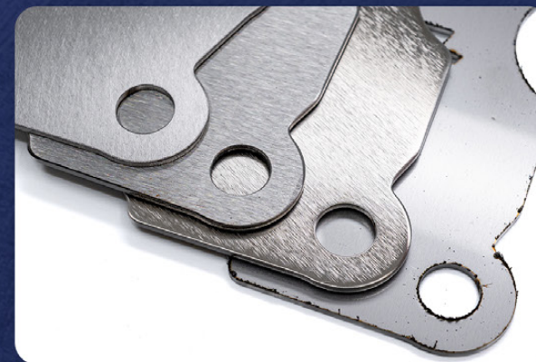
Odjehlení a finální povrch - nerez
