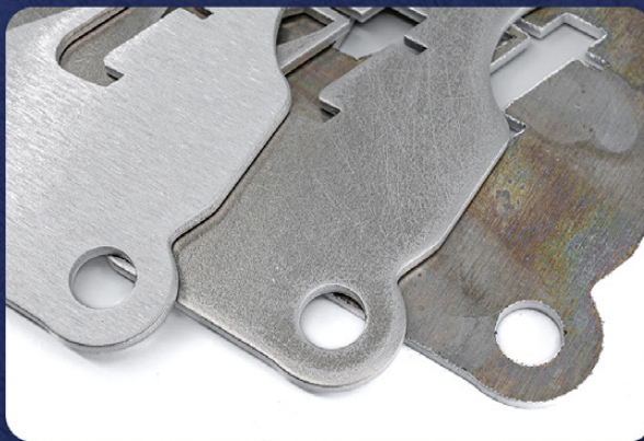
Odjehlení a zaoblení hrany u hliníku, vč. finálního povrchu
