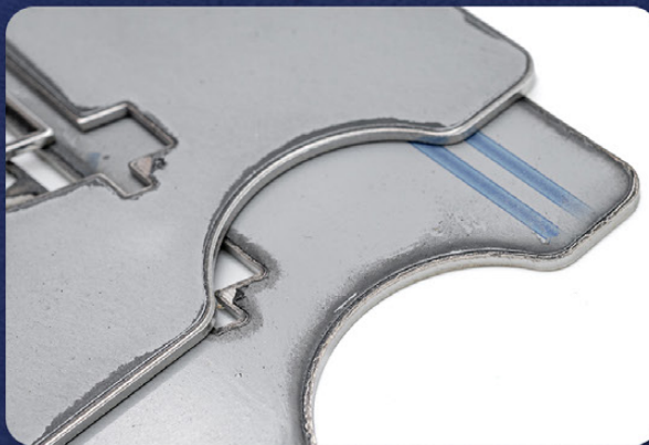
Zaoblení hrany u foliovaných plechů bez porušení krycí fólie
